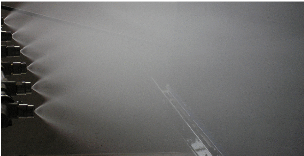
Рис. 4. Водяний туман у зоні роботи різцевої коронки, створений шістьма розпилювачами Ф.03.1.0.
