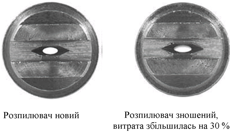
Рис. 2 Вигляд нового та зношеного розпилювача (фото Spraying Systems Co)
