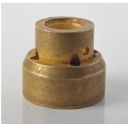
Рис. 3. Завихрювач відцентрового розпилювача бувший у використанні
